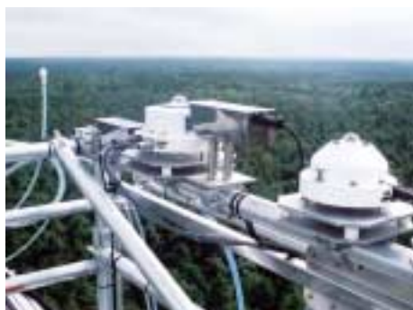
観測塔頂部に設置されている 光環境検出器類
