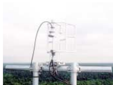
観測塔頂部に設置されている フラックス観測機器類
