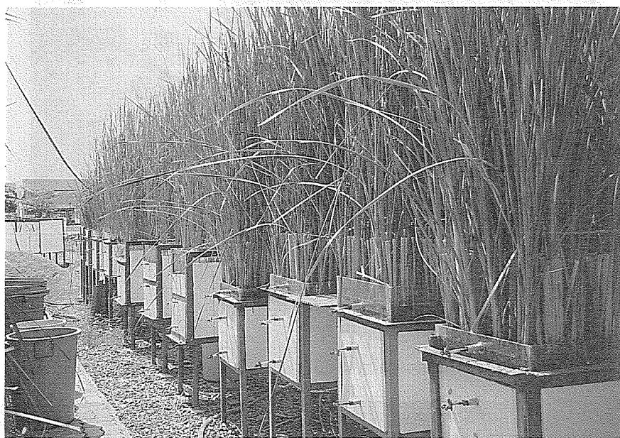
写真3 アジア工科大学(AIT)との水生植物植栽浄化法の共同実験プラント
