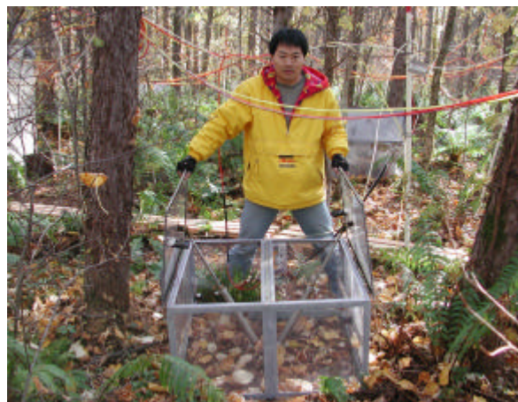
写真 16連の自動開閉チャンバー式 大型土壌呼吸自動観測システム
