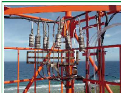
大気取り込み口 (鉄塔頂上にある空気取り入れ口、 ここから空気を取り込みます)
