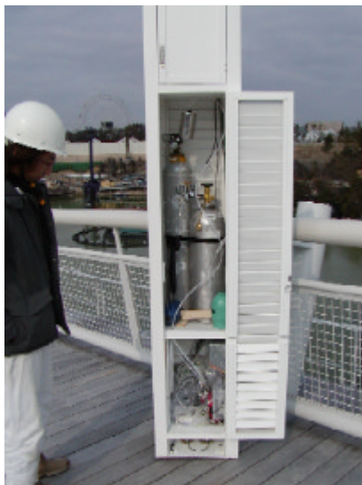
写真1 CO 2 濃度観測装置 百葉箱のように通気性に優れているが内部には雨が入らない構造になっている。2種の標準ガスを用い定期的に自動校正を行っている。
