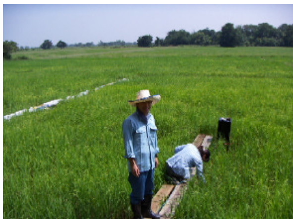
写真1 水田におけるメタンフラックス測定の様子
