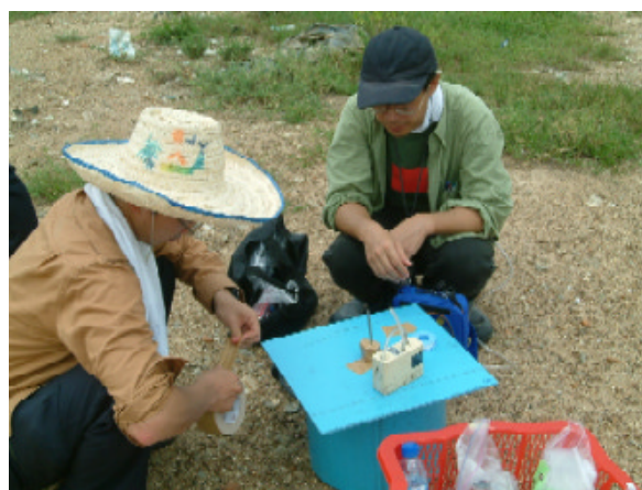
写真3 閉鎖型チャンバー (写真中央の筒及び蓋代わりの板)
