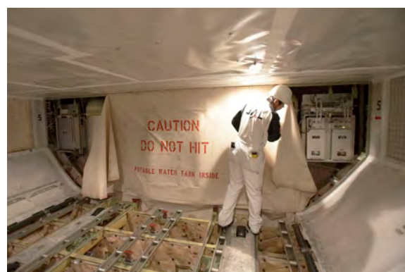
写真1 ボーイング 747-400 型機に搭載されている CO 2 濃度連続測定装置 (CME) (左) と改良型大気サンプリング装置 (ASE) (右)
