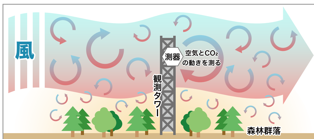
図1 森林群落の上を風が吹くと、大小さまざまなスケールの渦が発生し、これによりいろいろな物質の鉛直輸送が起ります。応答性の高いセンサーで計測された空気の鉛直方向の動きとCO 2 濃度の変動の関連から鉛直方向の輸送量を計算することができます
