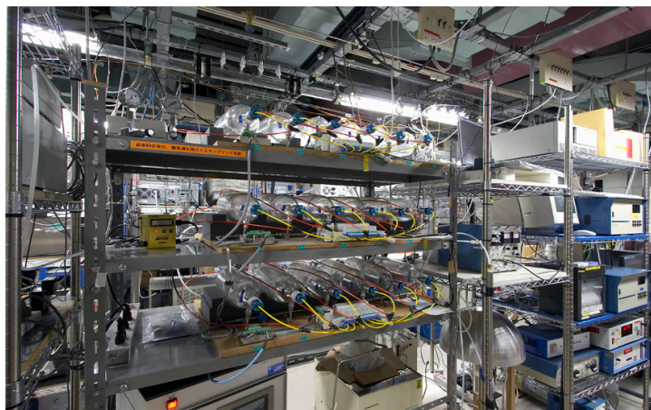
【地球環境モニタリングステーション-波照間内に設置された大気ボトルサンプリング装置(9ページ参照)】
