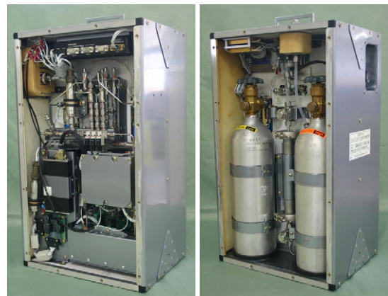
写真2 CMEの表面と裏面。裏面には2本の標準ガスが収納されている
