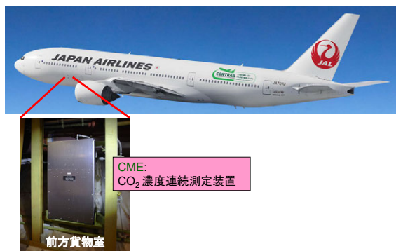
写真1 CMEはボーイング777-200ER型機の前方貨物室に搭載されている
