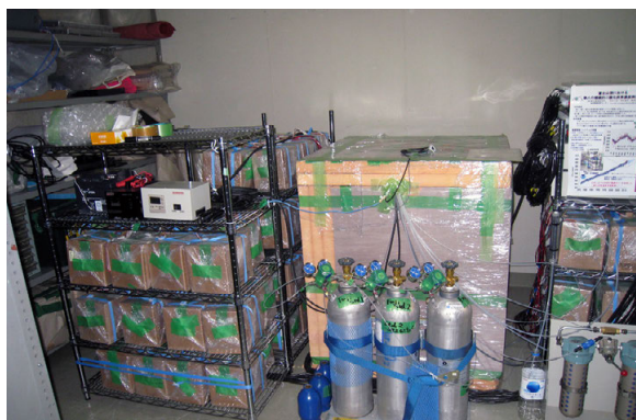
写真3 測候所一室にある大気中二酸化炭素濃度を通年観測する機器一式
