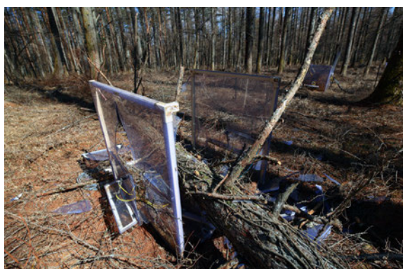
写真3 倒木により破損したチャンバー
