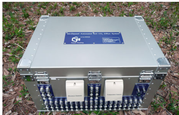
写真2 チャンバーを制御するコントロールボックスの操作パネル(左)と、配線・配管口(右)
