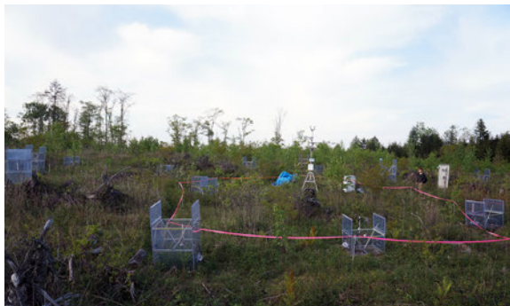
写真1 森林跡地に設置されたCO 2 測定用のチャンバー
