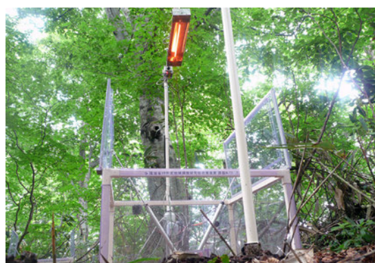
写真5 上部にヒーターを設置した温暖化操作実験
