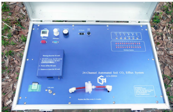
写真2 チャンバーを制御するコントロールボックスの操作パネル(左)と、配線・配管口(右)
