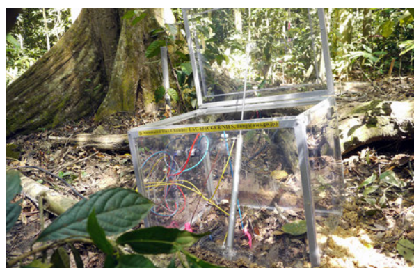
図2 パソ低地熱帯林に設置されている土壌呼吸チャンバー（左）と、観測データ（右）
