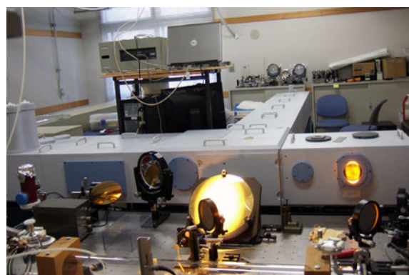
写真 1 国立環境研究所の地球温暖化研究棟 3 階に設置している大気観測用高波長分解能 FTIR。大気の吸収を受けた太陽光を測定しているところです。屋上に設置された太陽追尾装置からの太陽光を、手前の大きな鏡と右に続く 2 枚の小さな鏡を用いて FTIR に取り込みます。FTIR の「T」の字の交わっている部分に、干渉計の半透鏡と固定鏡があり、奥の長い部分に移動鏡があります。更に、左側に検出器があります。
