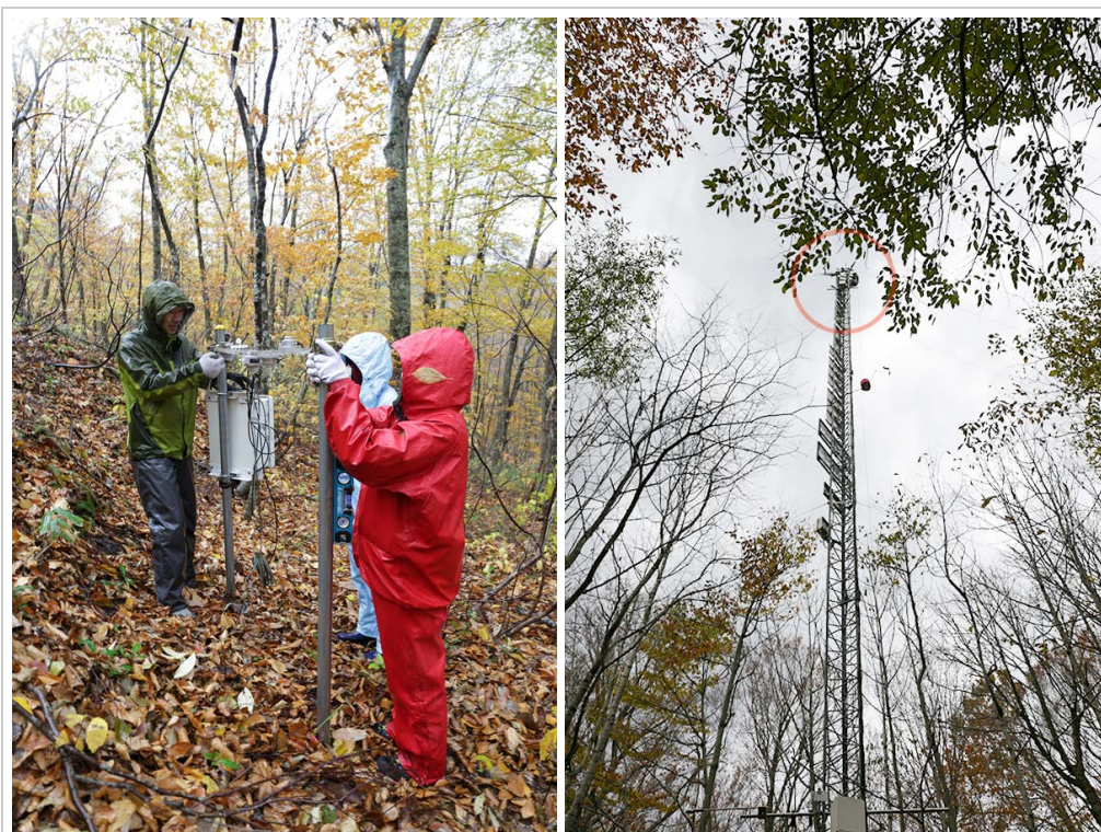
写真1,2 森林内に設置した放射計を取り外し、高さ34mのタワー頂上でデータの回収を行う弘前大学石田祐宣助教の調査チーム
