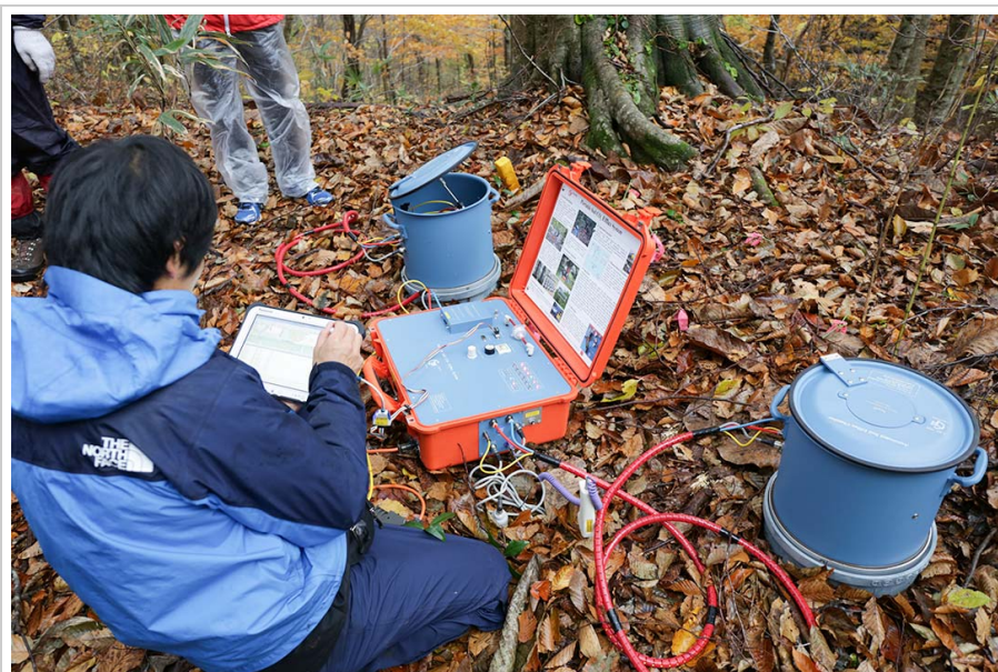
写真4 研究所で開発された新型の可搬型土壌排出CO 2 測定器により測定を行う地球環境研究センターの寺本宗正特別研究員
