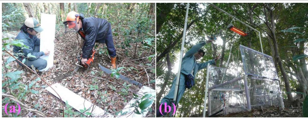
写真1 宮崎のコジイ林におけるチャンバースystem設置時の (a) 根切り作業、(b) 温暖化区のチャンバートとカーボンヒーター
