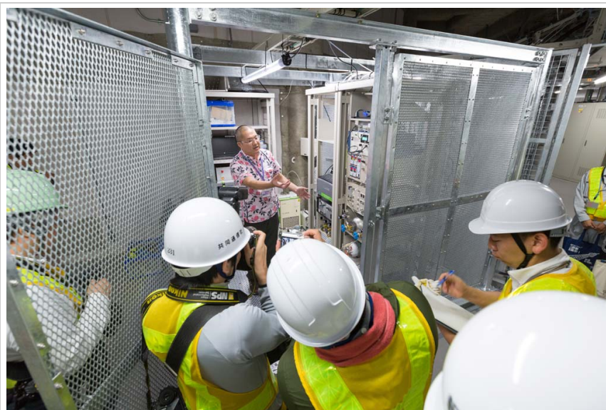
写真2 観測現場の説明。この観測スペース内に、二酸化炭素、メタン、一酸化炭素、酸素の大気中濃度を現場で分析する装置と、大気を実験室に持ち帰って炭素同位体比などを分析するためのフラスコサンプリング装置があります
