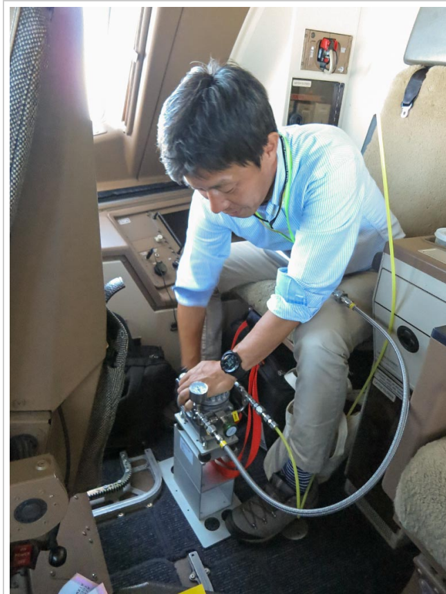
写真1 MSE観測の様子（ポンプを回して空気を採取しています）
