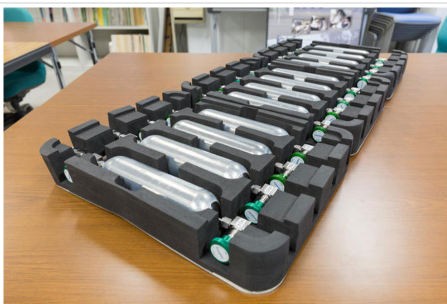
写真3 MSE用金属フラスコ（12本のフラスコで12カ所の大気を採取します）
