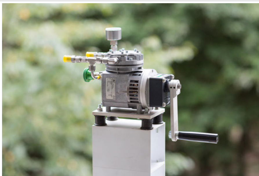
写真2 MSEポンプ（右側に見えるのがポンプを回すためのハンドル）
