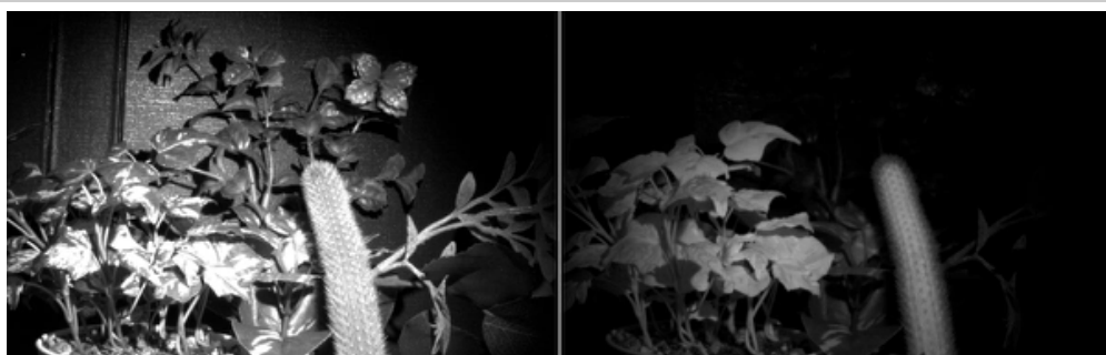
写真3 左は可視域から近赤外域を捉えるカメラで植物（ツタ）と造花、サボテンを写した様子。右はクロロフィル蛍光の波長（750nm付近）のみを透過する光学フィルターを通して見た様子。光学フィルター越しの写真（右）には造花とサボテンの棘は写りません
